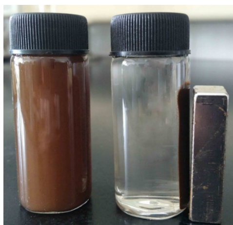
图 5 吸附完 Pb 2+ 离子的磁性纳米伊/蒙黏土浆料未经过和经过磁分离的情形
